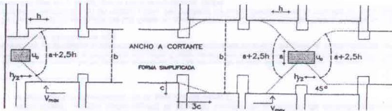
Figura 54.9 Ancho de cálculo a cortante
