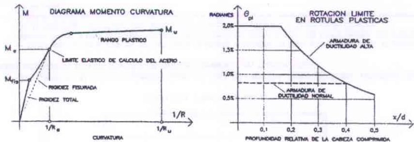
Figura 21.2 [ Rotación límite en rótulas plásticas ]
